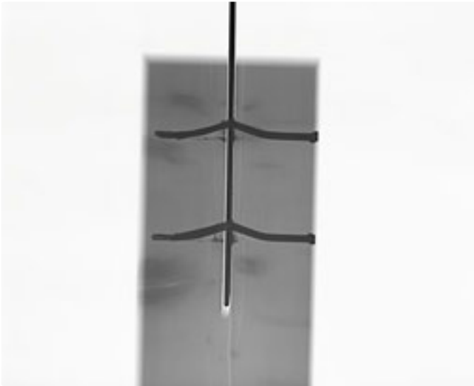
Im Röntgenbild deutlich erkennbar: Fließgelenkausbildung bei stiftförmiger Holz-Stahl-Verbindung
